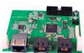
Módulo de comunicación para redes de hasta 32 sistemas. Permite la conexión en anillo o estrella.
