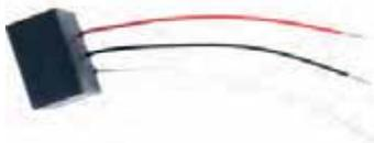
Módulo final de línea para cerrar las líneas de altavoces del sistema de alarmas por voz VARIODYN® D1, garantizando el cumplimiento de la norma, en cuanto a la monitorización de las líneas, si existen más de 20 altavoces conectados por línea. El módulo se debe conectar después del último altavoz de la línea. Independiente del número y potencia de los altavoces conectados.
