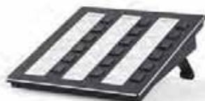
Módulo de teclado digital para ampliación del nº de pulsadores de las estaciones de llamada DCS Plus. Con 18 pulsadores totalmente configurables y 18 leds. Es posible la conexión de hasta 6 módulos DKM Plus a las estaciones de llamada DCS Plus. Esto permite la comunicación de la estación con hasta 120 zonas.
