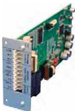
Módulo de zona A para matrices de control MX6Z-AN o MX8Z-AN. Dispone de conector para entrada y salida del amplificador, conector para la línea de 100V y dos entradas digitales monitorizadas para activaciones. Cuenta con memoria interna para almacenar hasta 2 mensajes de audio pregrabados. El módulo MZA-AN gestiona el amplificador y la línea de altavoces. En caso de avería del amplificador el módulo activa la conexión automática al amplificador de reserva si lo hubiese.
