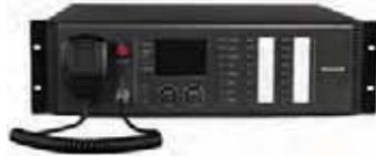
La unidad de control RK-MCU es el dispositivo de central de gestión del sistema INTEVIO, que se utiliza para gestionar y supervisar todos los dispositivos y ejecutar las diferentes funciones. La RK-MCU ofrece funciones de almacenamiento de audio, reproducción, control de zona, supervisión, control de temporización y diagnóstico de averías. El amplificador de 500W de potencia integrado puede alimentar hasta 8 líneas de altavoces, también integradas, para pequeñas aplicaciones.
