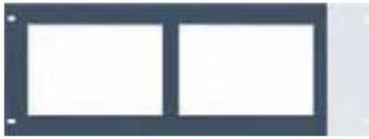
Panel ciego para rack 19", para el montaje opcional de 2 estaciones de llamada DCSF en el interior del propio armario. Las dimensiones del panel son equivalentes a 4 HU y dispone de dos troqueles para la ubicación de las estaciones de llamada o ampliaciones de teclado DKM18, así como orificios adecuados para su fijación mediante tornillos.
