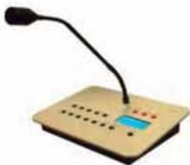
Estación de llamada EN54-16 con teclado numérico de "0 a 9" y display. Dispone de tres teclas de operación y tres de activación de mensajes además de leds de "ocupado" y "sistema". Todas las funciones son completamente programables por software.
