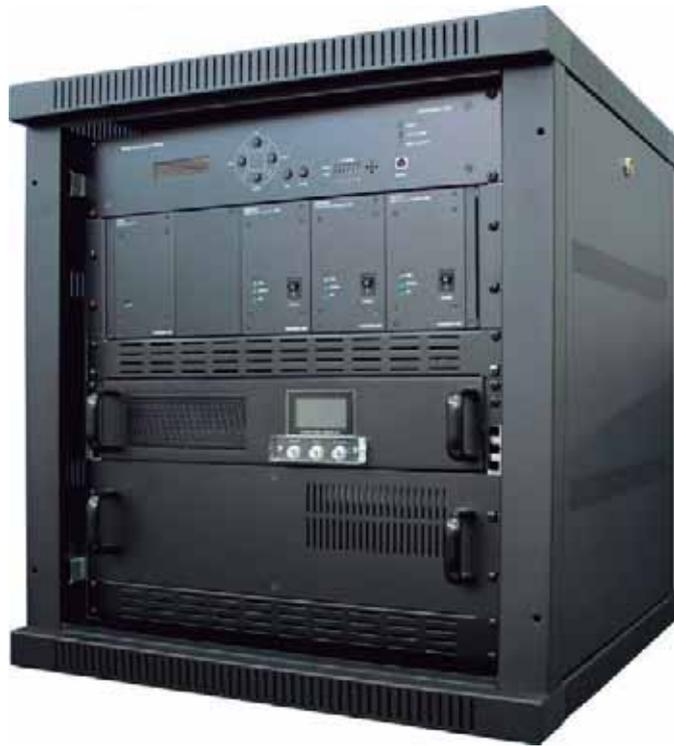
El sistema AUDIONET MX es una solución modular que permite una gran flexibilidad. Para cada zona podrá asignarse un amplificador digital de 120 W, 240 W o 480 W optimizando así la configuración. Con una capacidad máxima de 110 líneas, pudiendo ser éstas líneas sencillas o líneas A/B.
