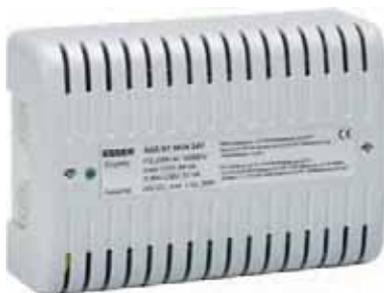
Fuente de alimentación 24 Vdc / 1,5 A para activar los relés de emergencia de los reguladores de volumen. Adecuada para montaje en superficie, en interiores.
