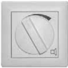
Regulador de potencia para líneas de 100V y relé de emergencia a 24 Vdc. Diseñado para sistemas de alarmas por voz en instalaciones con 4+2 cables. En caso de emergencia, la actuación del relé asegura la emisión del mensaje, con el volumen adecuado, enviando la señal de sonido directamente al altavoz.
