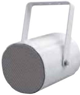
Proyector acústico de aluminio, certificado de acuerdo con EN54-24 y conforme a BS5839-parte 8, con transformador para línea de 100V y transductor de banda ancha de 5,25" protegido contra humedad. Incluye conectores cerámicos y fusible térmico para incremento de la seguridad pasiva.
