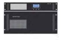
Fuente de alimentación de emergencia de 800W potencia con display. Cuenta con interruptor de corte de emergencia y salida de señal de avería. Incluye 3 baterías de 12V 55Ah. Para montaje en armario rack de 19"
